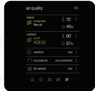
L'écran **de qualité de l'air\*** affiche les niveaux de qualité de l'air intérieur lorsqu'un dispositif de surveillance de l'air intérieur Daikin One est connecté. La qualité de l'air extérieur et la météo seront affichées si il y a une connexion à Internet et qu'un thermostat a été ajouté dans l'application mobile sous l'emplacement du domicile.
